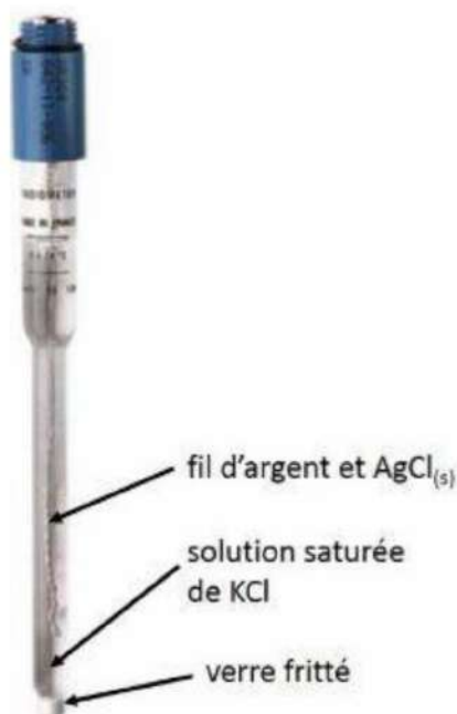
Figure III.12 : électrode au chlorure d'argent.
