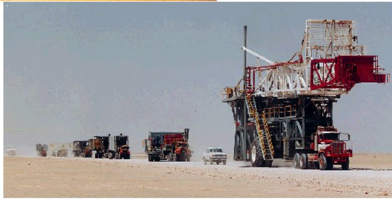
Opération DTM (Démontage, Transport, Montage).
