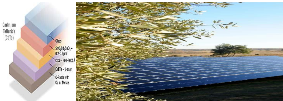
Figure I.22 . Les cellules solaires à base de couches minces de tellure de cadmium. [58].
