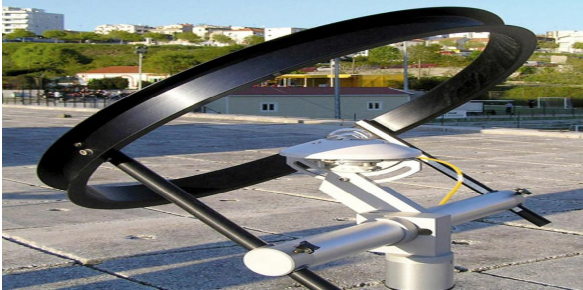
Figure I.7 . Pyranomètre CMP3 avec anneau d'ombre pour détecter le rayonnement global diffus[24]
