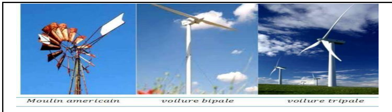
Figure I-24: Technologie éolienne à axe horizontale [7].
