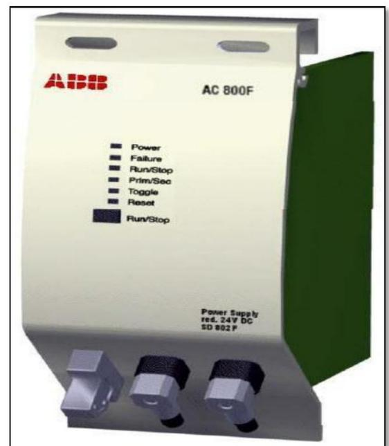
**Figure III.8: Module d'alimentation SD 802F de l'AC 800F [11]**
