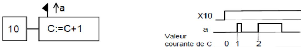
Incrémentation du compteur C sur le front montant de « a », l'étape 10 étant active.
