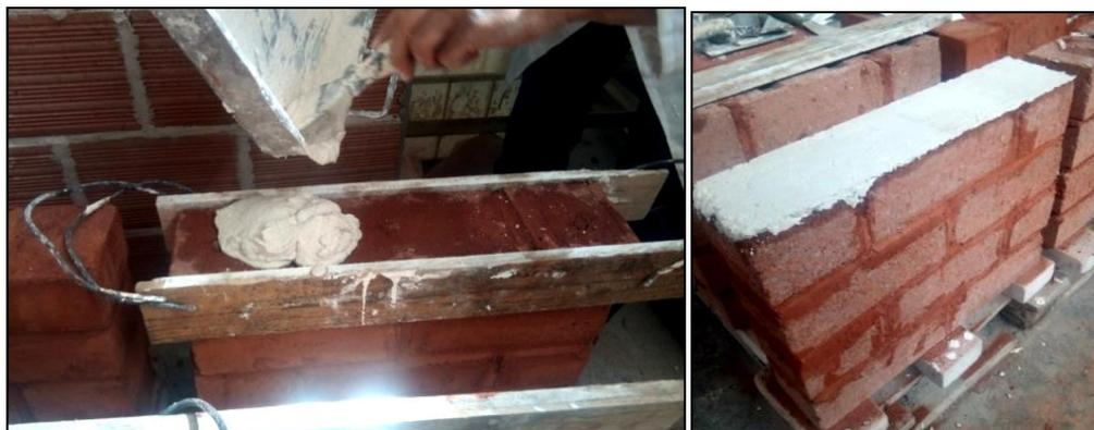
**Photo V. 9 :** Surfaçage des murets par une couche de 1cm de plâtre.
