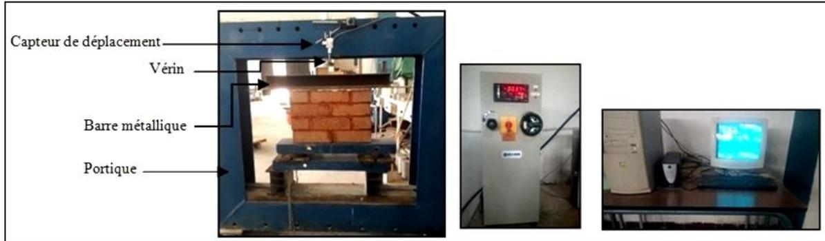
**Photo V. 10 :** Dispositif des essais sur murets.
