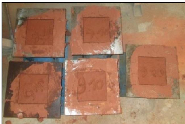
**Photo IV. 2:** Moulage des briques en terre crue pour les essais préliminaires.
