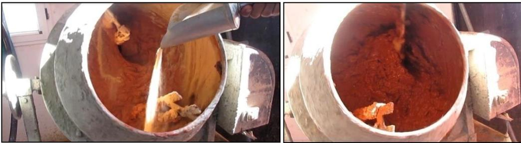
**Photo IV. 1** : Malaxage mécanique des adobes destinés aux essais préliminaires.
