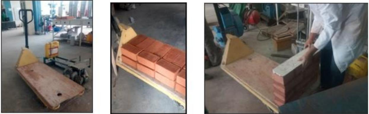
**Photo V. 3 :** Transpalette pour le déplacement des adobes et des murets après séchage.
