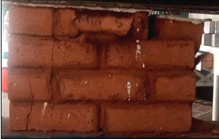
**Photo V. 13** : Rupture du muret type C : apparence de la première fissure à  $t=26s$  ; Rupture du muret à  $t=63s$ .
