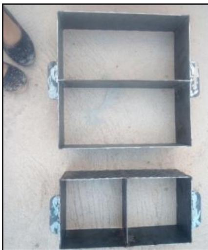
**Photo IV. 5 :** Moules métalliques sans fond de dimensions  $29 \times 14 \times 9 \text{ cm}^3$  pour les adobes entiers, et  $14,5 \times 14 \times 9 \text{ cm}^3$  pour les demi adobes.
