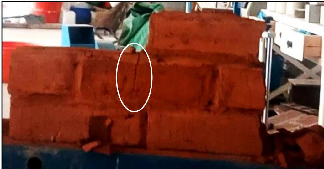
**Photo V. 12** : Rupture des murets de type B.
