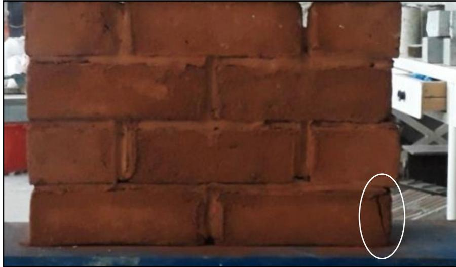
**Photo V. 11** : Rupture des murets de type A : apparence de la première fissure à  $t=34s$  ; rupture à  $t=42s$  ;
