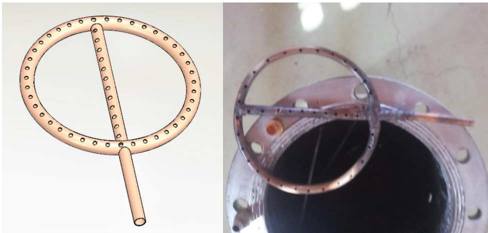
Figure 21 : Système de répartition de l'agent de gazéification
