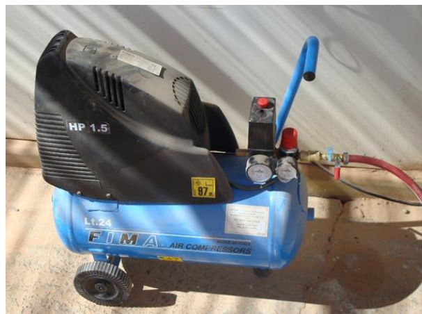
Photo 22 : Compresseur d'air F.I.M.A
