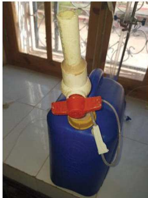
Photo III. 8: Réacteur de l'inoculum
