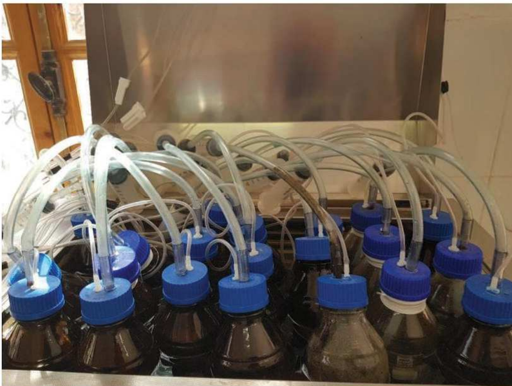
Photo III. 10: Digesteurs incubés dans un bain-marie à 37,0 \pm 0,1 °C.
