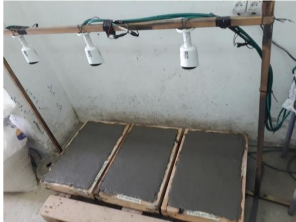
Figure 3.18. Mesure de la fissuration dans les dallâtes à l'aide des caméras.
