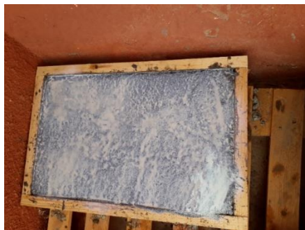
(c) Béton traité par cure
