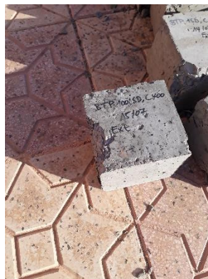
Figure 3.12. Éprouvette après écrasement.
