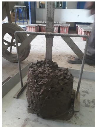
Figure 3.9. Mesure de l'affaissement du béton au cône d'Abrams.
