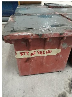
Figure 3.10. Éprouvette avant démoulage.
