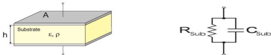
Figure III. 22: Substrat bloc et circuit équivalent.
