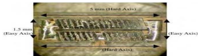
Figure II. 18: Micro-inductance fabriquée à base de Ni-Fe d'environ 5 mmx2 mmx0.25 mm, Herriot Watt University, Scotland, in 2009 [23].
