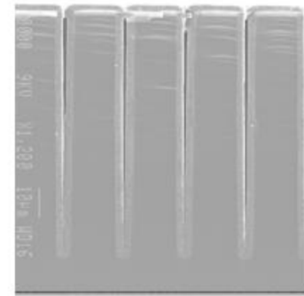
Figure I. 13: Vue en coupe des tranchées avec dépôt de polysilicium .
