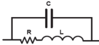
Figure III. 16: Modèle RLC d'une inductance planaire.
