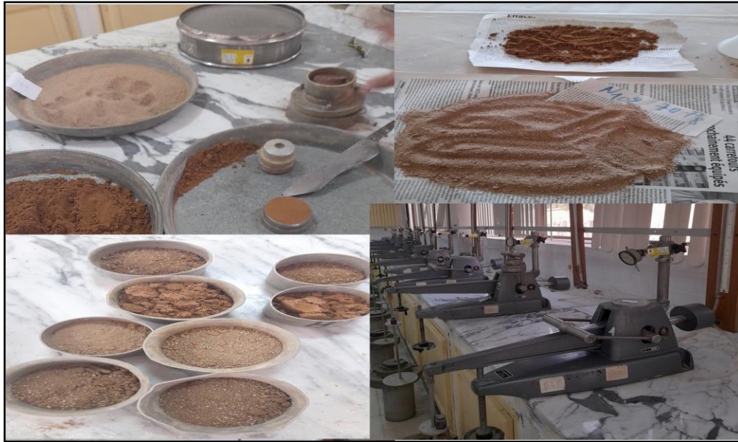
Photo V-4 : Essais de perméabilité (Laboratoire : LTPE-Sétif ; Février 2021).
