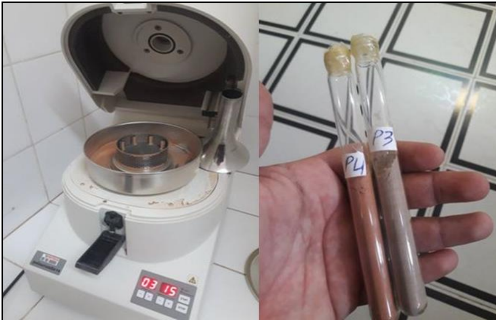
Photo IV -8 : Phase 3, broyage des échantillons tamisés.
