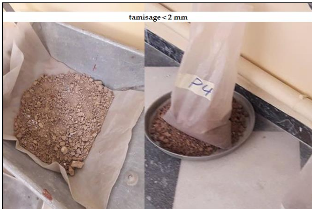
Photo IV -7 : Phase 2, tamissage des échantillons à travers un tamis 2 mm.
