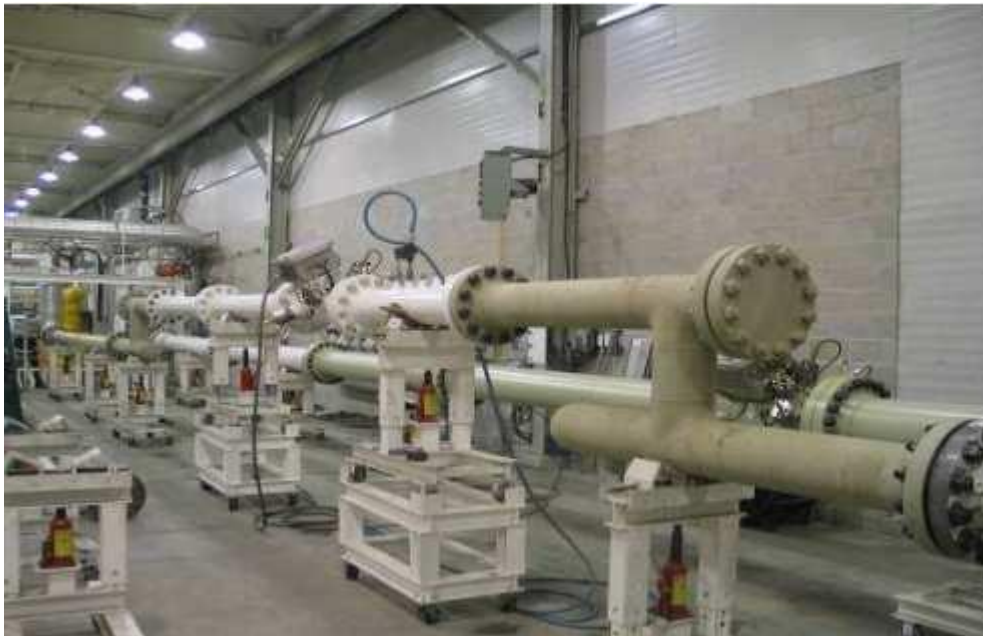
Figure 3.4 - Débitmètre installé dans un centre d'étalonnage[24].
