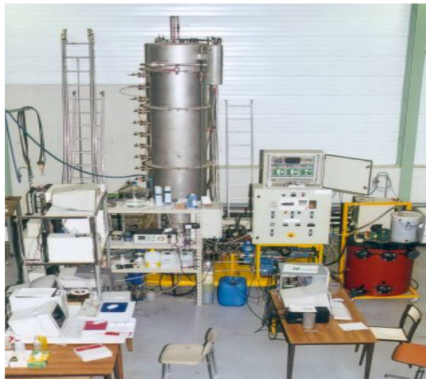
Figure II-8 : Photographie du réacteur pilote pour le traitement des vinasses de distillerie et son instrumentation
