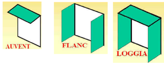
Figure I-5: différents type de protection solaires fixes
