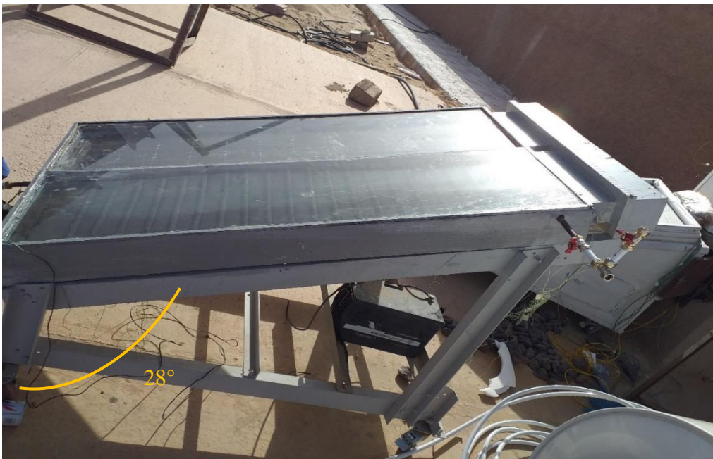
Figure IV.14. Image montrant l'angle d'inclinaison du support métallique.
