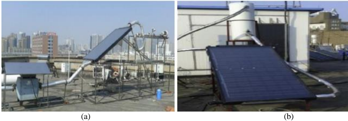
Figure I.20. Configuration expérimentale développée par Chao Guo et al. [9] : (a) mode PV/air ; (b) mode PV/eau
