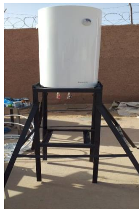
Figure IV.5. Image du ballon de stockage
