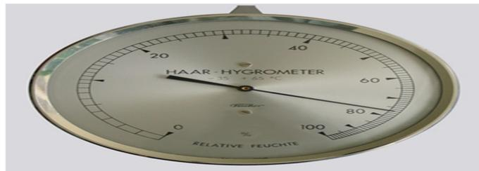
*Figure N°.IV.4 Hygromètre à cheveux.[22]*
