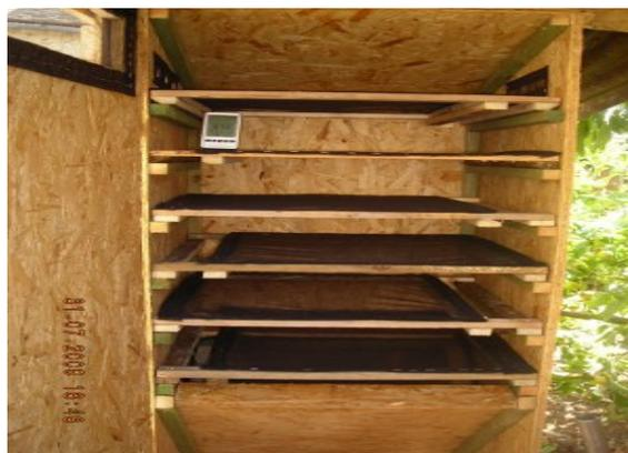
*Figure N°IV.9: Chambre du séchoir solaire indirect[22]*
