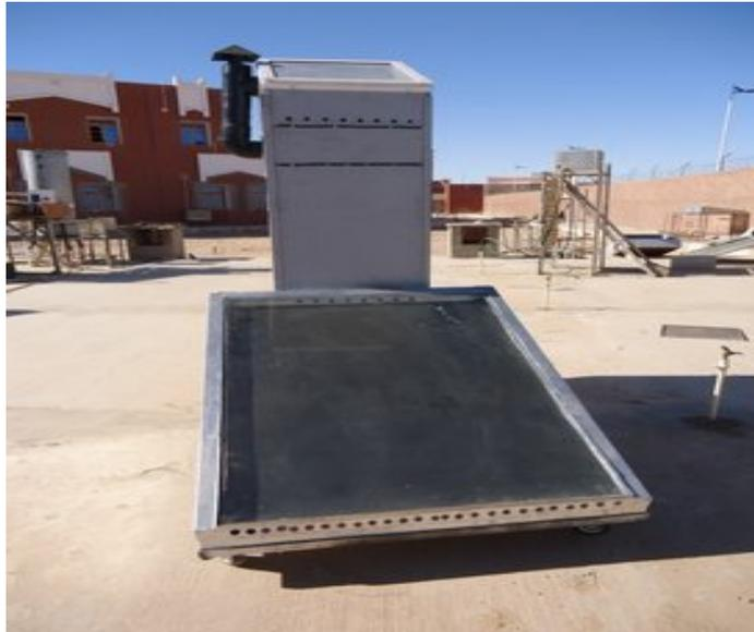
*Figure N°IV.10: Séchoir solaire mixte.[4]*
