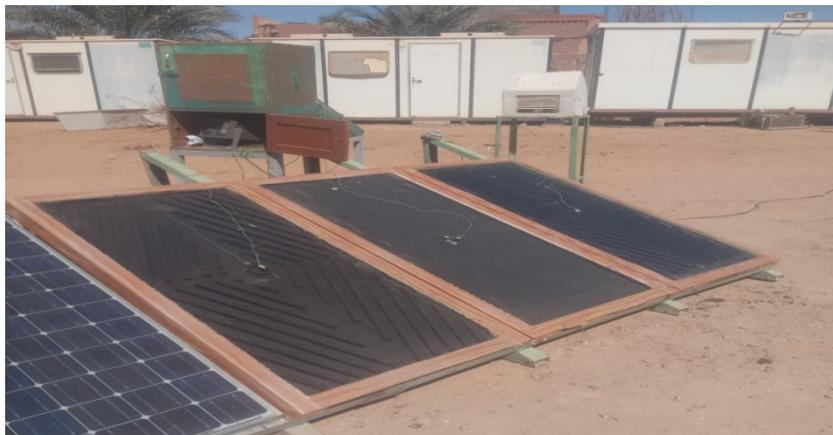
Figure N°. II.29: Capteurs solaires à air
