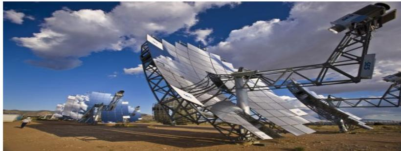
**Figure N°. II.7 : Capteur parabolique**
