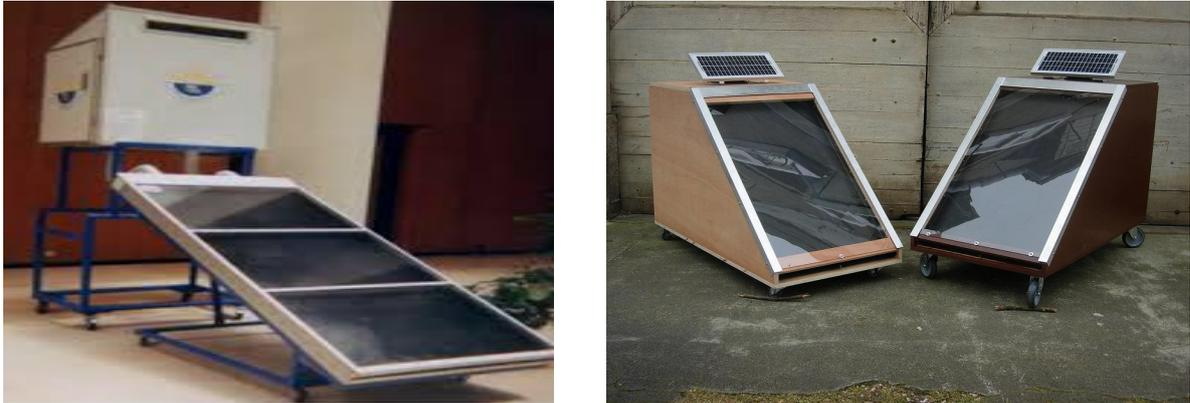
*Figure N°IV.11: Séchoir solaire hybride.[4]*
