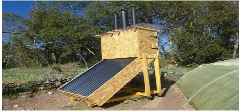
*Figure N°IV.8: séchoir solaire de type indirect [4]*
