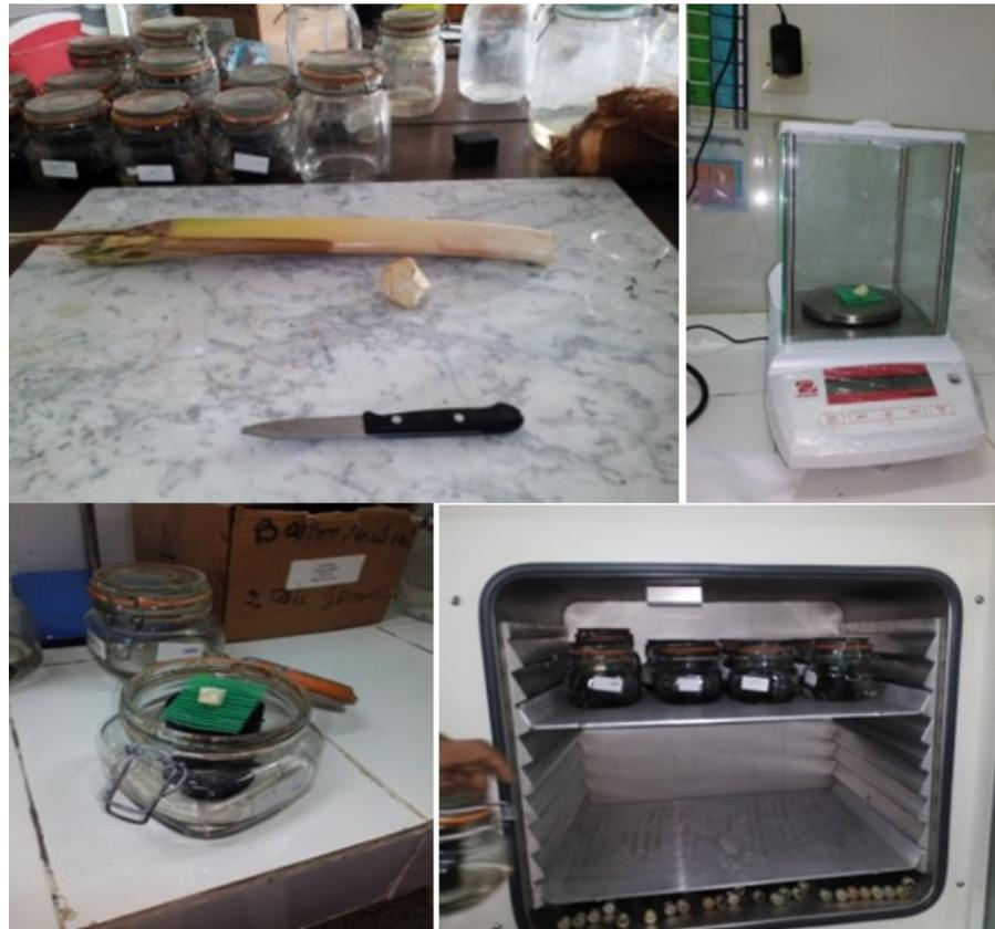
*Figure N° III.4. Appareillage pour la détermination des isothermes de sorption*
