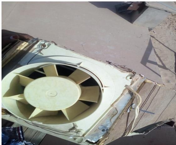
*Figure N°.II.36. Le ventilateur utilisé dans le capteur solaire(CF)*
