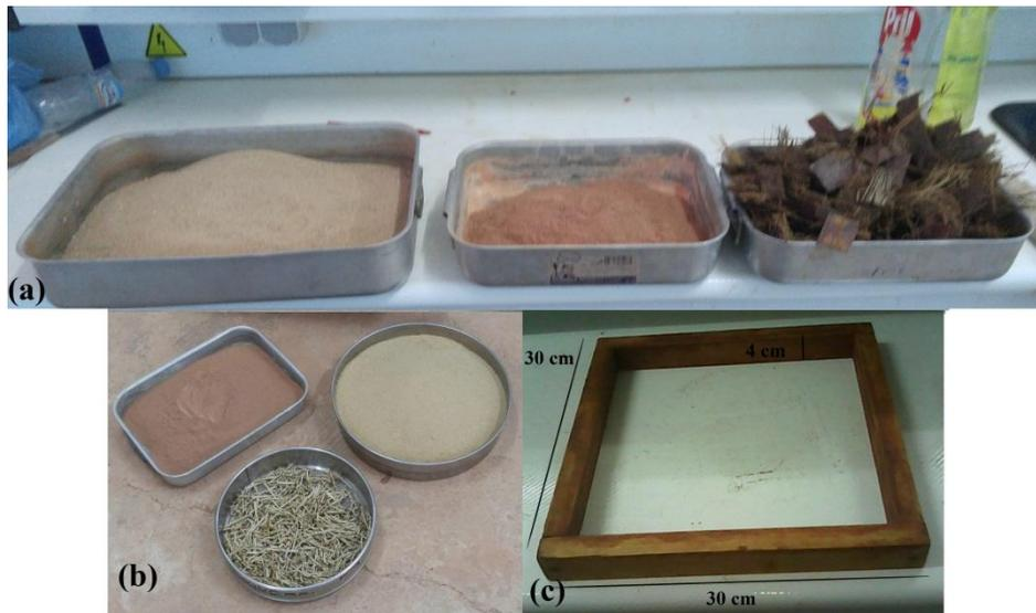
Figure.III.1. Les matériaux utilisés pour le mélange (a) Fibre de palmier dattier. (b) Épillet de palmier dattier. (c) Dimension du notre moule.
