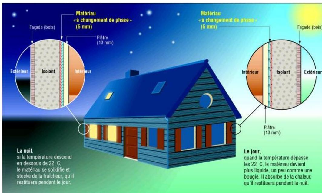
Figure.I.6. Principe de fonctionnement du PCM système. [8]
