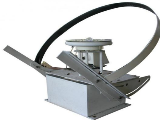
Figure II.2 : l'instrument qui mesure le rayonnement diffus
