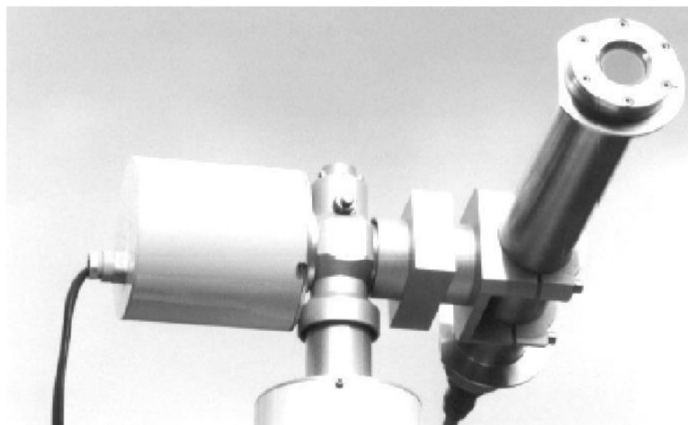
Figure II.1 : Appareil de mesure le rayonnement direct
