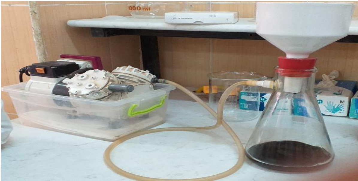
Figure III-3 Filtration des huiles usagées
