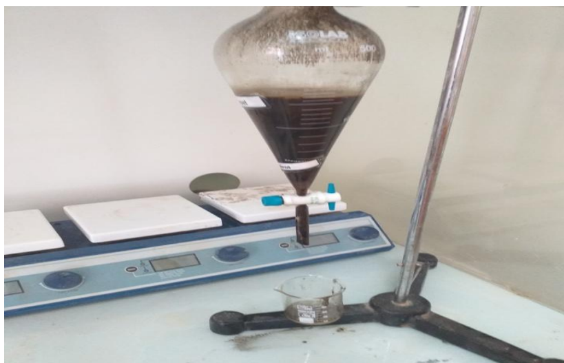
Figure III-8 Lavage par l'eau chaude
