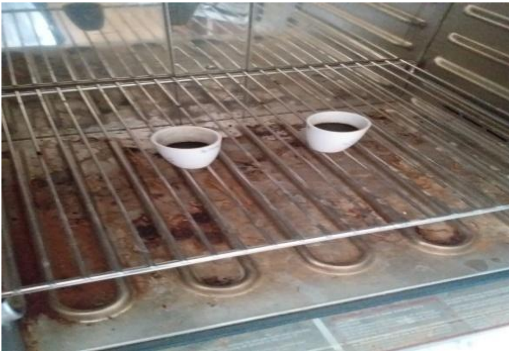
Figure III-16 Détermination de teneur en eau
