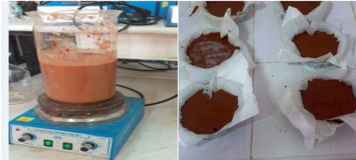
Figure III-12 Activation de l'argile par l'acide H_2SO_4
