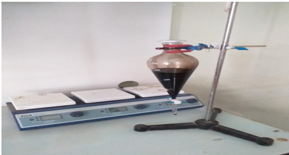
Figure III-6. Décantation des huiles usagées après 72h
