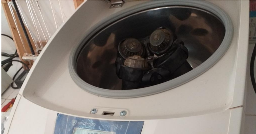
Figure III-4. Centrifugation des huiles usagées
