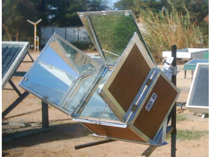
الشكل 1: صورة توضح نموذج المطبخ الشمسي علبة المصنوع ب "و.ب.ط.م.و.ص" بأدرار
