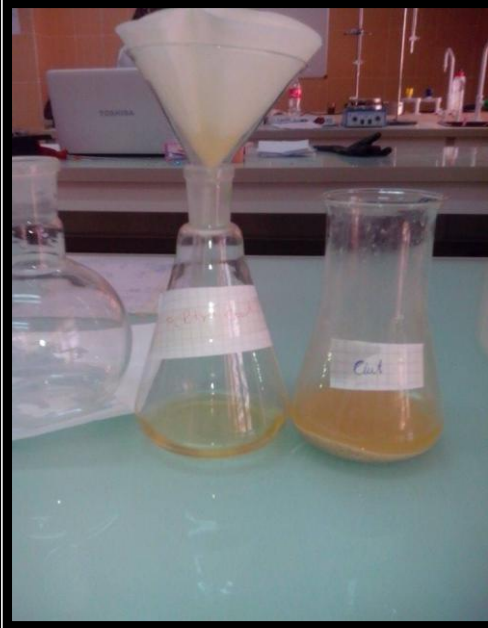
Figure 16 : La filtration de l'extrait.
