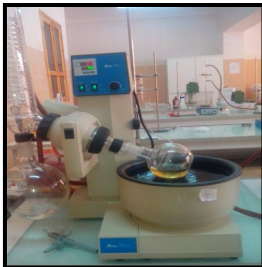
Figure 18 : Evaporation des solvants d'extraction dans un rotavapor
