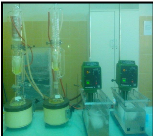
figure 20 : Extraction des flavonoides dans montage soxhlet .
