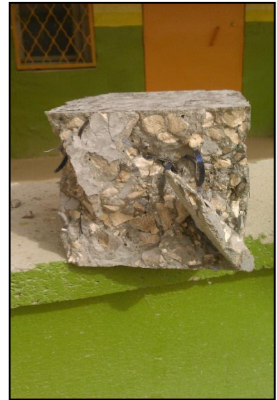
Photo VI.22: L'état de l'éprouvettes après une série de quatre rechargements successifs
