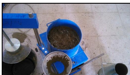
Photo V.17: Essai de VEBE.
