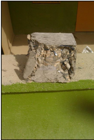
Photo VI.22: L'état de l'éprouvettes après une série de quatre rechargements successifs
