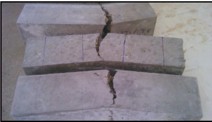
Photo VI.27: La forme des éprouvettes avec BFMN après la destruction.
