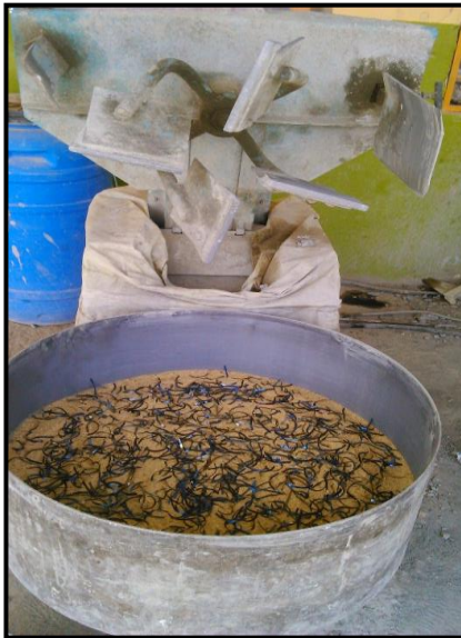
Photo V.18 : Outillage de préparation et confection des éprouvettes (Malaxeur verticale, Moules cubiques, prismatiques et vibreur)
