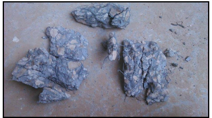
Photo VI.27: La forme des éprouvettes avec BFMN après la destruction.
