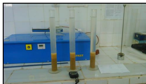
Photo V.10: l'essai de l'équivalent du sable
