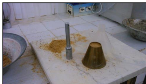
Photo V.12: Essai de détermination Coefficients d'absorption de l'eau
