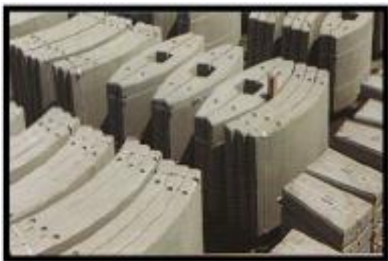
Le béton fibré pour les ouvrages préfabriqués (voussoirs des tunnels)
