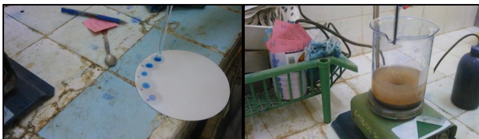
Photo V.11 : L'essai de bleu de méthylène
