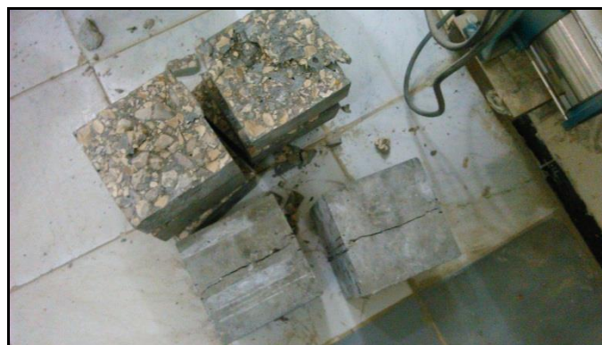
Photo VI.25: Des différents éprouvettes sans et avec fibres métalliques après l'essai de fendage.
