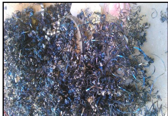
Photo V.6: Résultats de chanfreineuses après l'opération de fraisage
