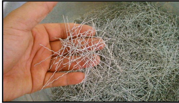
Photo V.8: Fibres normalisées d'une forme ondulée.
