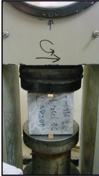
Photo V.21: La position correct des éprouvettes pour l'opération de traction par fendage
