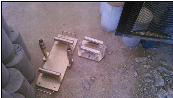
Photo V.20: Dispositif pour la flexion sur 4 points
