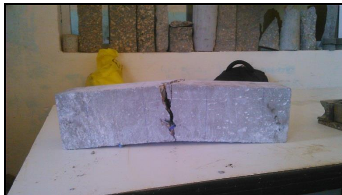
Photo VI.24: L'état de l'éprouvettes BRFM après 4 rechargements successifs.
