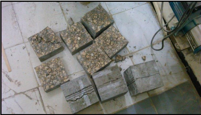
Photo VI.26: Comportement des éprouvettes BRFMN lors les essais mécaniques
