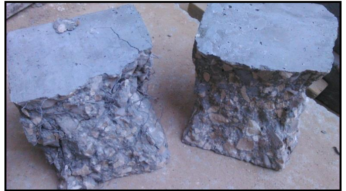
Photo VI.26: Comportement des éprouvettes BRFMN lors les essais mécaniques
