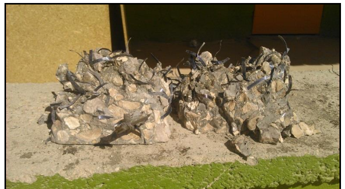
Photo VI.23: La distribution des fibres dans le béton
