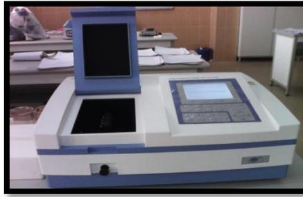
Photo 11- Spectrophotomètre-UV- visible
