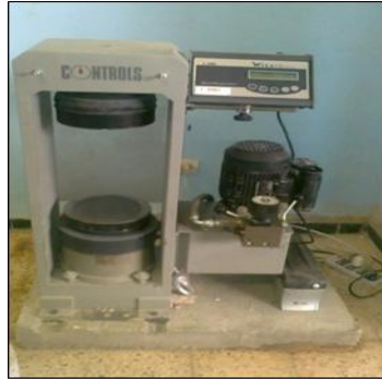
Figure. II.14. Appareillage de l'essai d'écrasement
