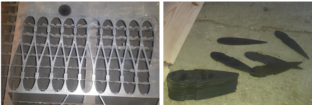
Figure 4.2 : Deuxième étape de fabrication des pièces du profil de la pale ; (a) Machine de découpe de laser ; (b) la découpe des profils.
