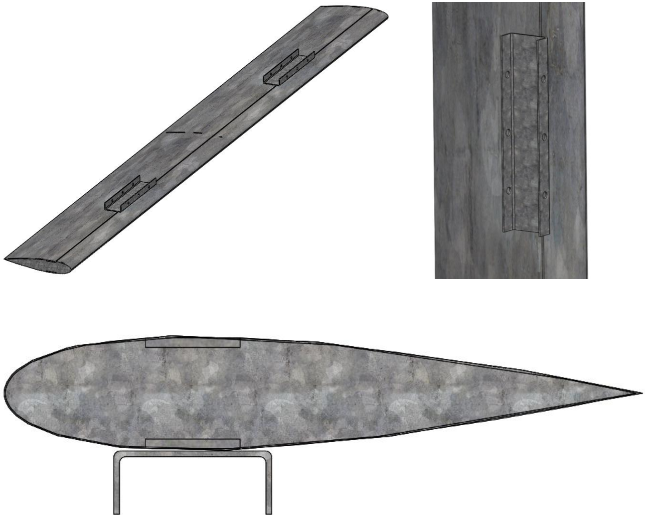
Figure 2.12 : Structure de la pale en acier galvanisée.
