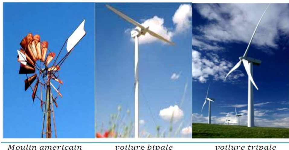
Figure 6 : technologie éolienne à axe horizontale
