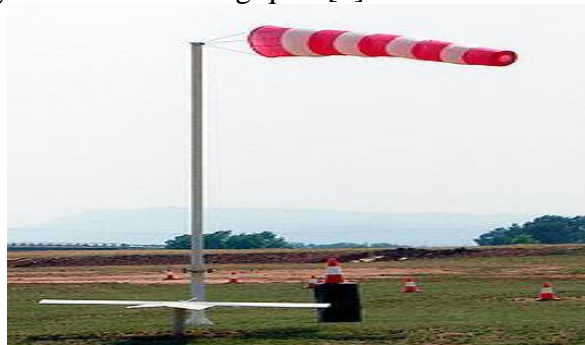
Figure 5 : Une manche à air permet d'évaluer approximativement la vitesse du vent et sa direction.
