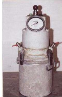
pomper (= mise en pression de la chambre) et ajuster l'aiguille au trait rouge puis relâcher
