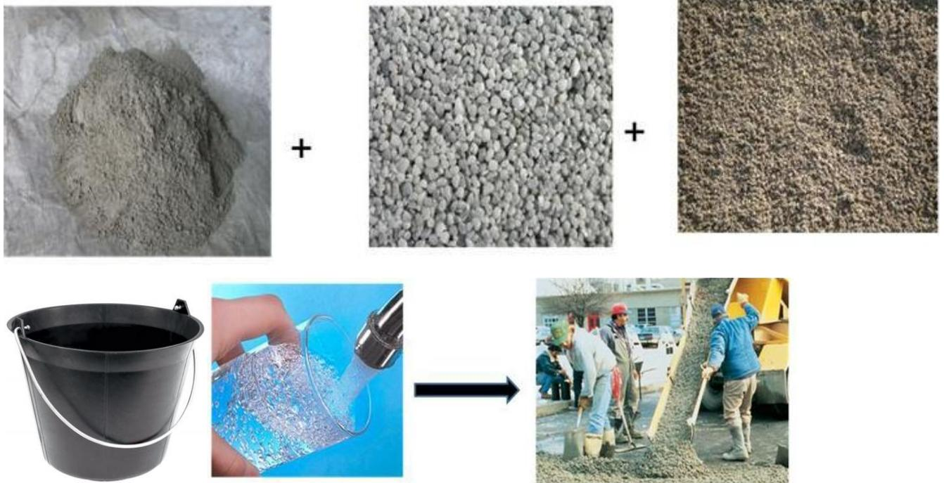
*Figure.04 les composant de bétons*
