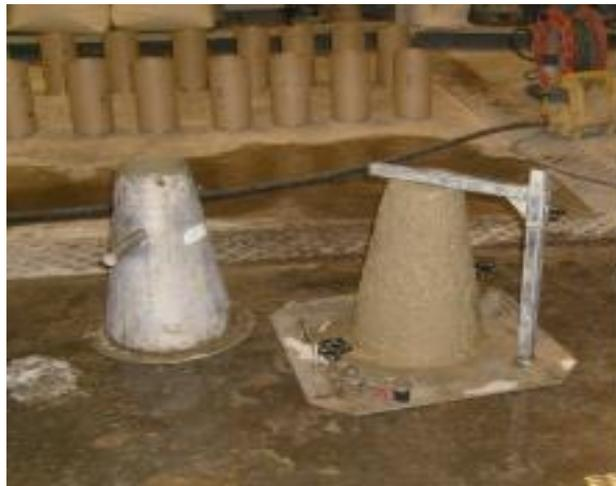
**Figure.07** Étalement à la table à chocs (cône DIN) NF EN 12350-5 [6]
