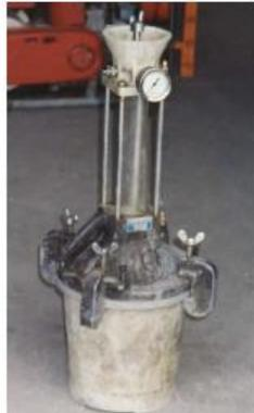
mise en oeuvre du béton en 3 couches avec serrage à refus
