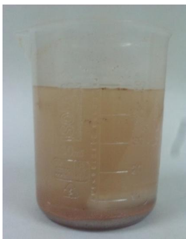
Photo IV.19 : Mélange de sable et de solution d'acides dans un bécher en plastique.
