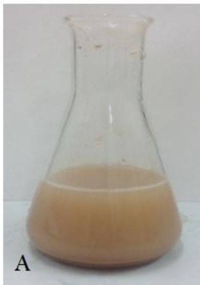
Photo IV.10 : (A) Lavage du sable par l'eau distillée. (B) Filtration du sable.
