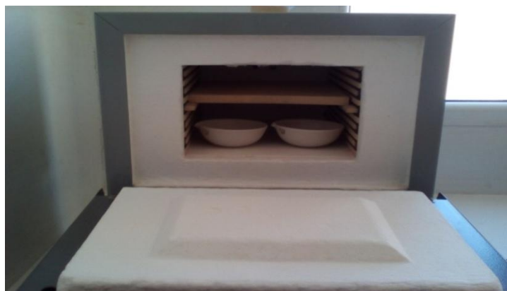
Photo IV.7 : Montrant les creusets dans le four à moufle.
