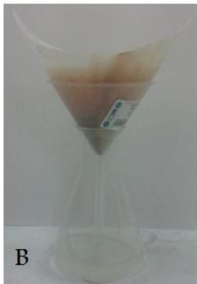
Photo IV.10 : (A) Lavage du sable par l'eau distillée. (B) Filtration du sable.
