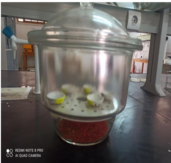
Figure 07: Refroidissement des échantillons
