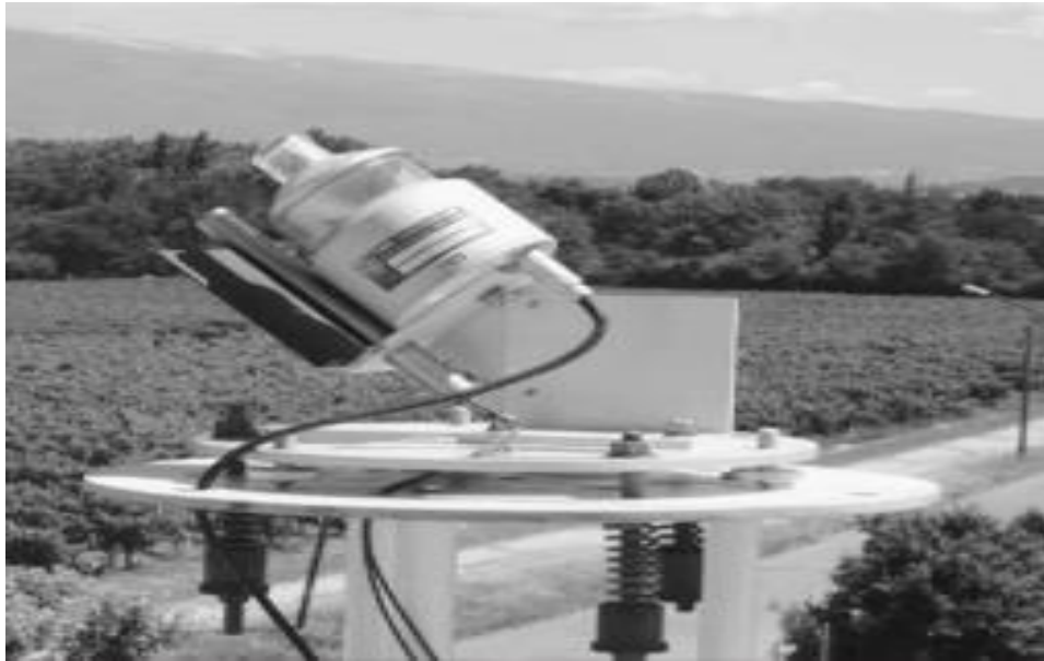
Figure 2- 7 : L'héliographe de Campbell-Stokes [13].
