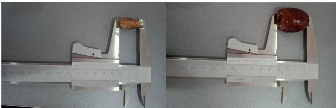
**Figure 14** : Pied colis (outil) pour mesurer la longueur/largeur des dattes/noyaux.
