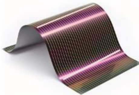
Figure 2.13 Cellule sans silicium en couche mince CIS / CIGS
