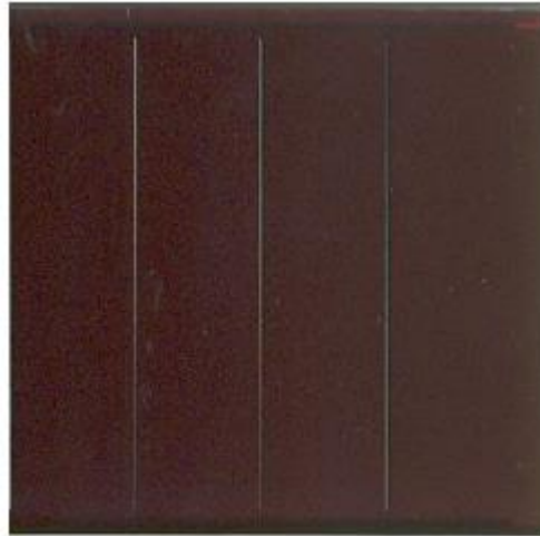
Figure 2.12 Cellule silicium amorphe en couche mince
