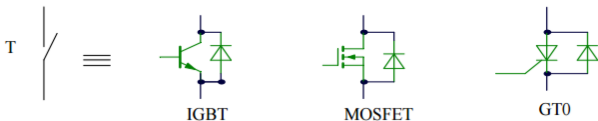
Figure (III.5) Interrupteurs de puissance
