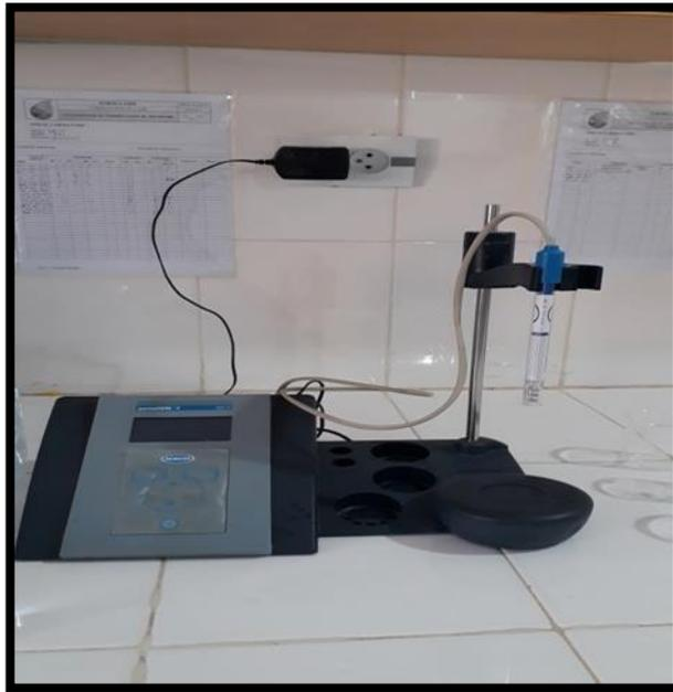
**Photo 2:** conductimètre utilisé. ( photo original )
