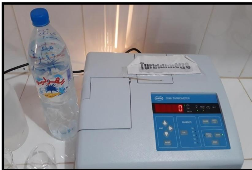
**Photo 3:** Turbidimètre. ( photo original )
