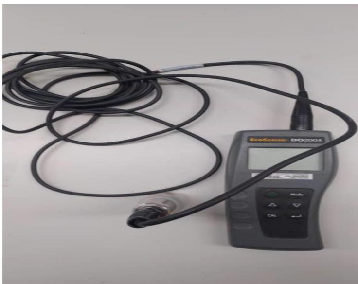
Fig III.11 Image Appareil de mesure de l'oxygène dissous EcoSense DO 200A
