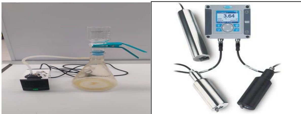
Fig III.10 Images l'appareil TSS JAVAC
