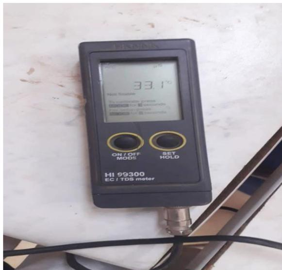
Fig III.6 Image d'appareil conductivité mètre Hi 99300 EC/TDS mètre
