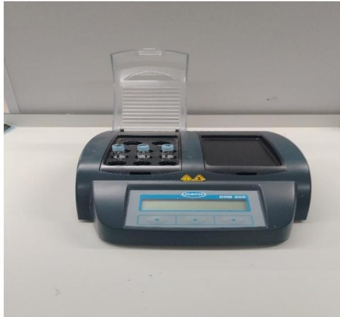
Fig III.8 Imagede réacteurCOD HACH DRB 200
