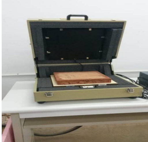
Figure III.14: L'appareil de conductivité thermique (plaque chaude et plaque froide) [Auteur].
