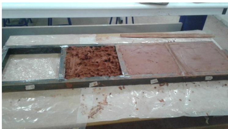
Figure III.19: Rempli le moule. [Auteur].
