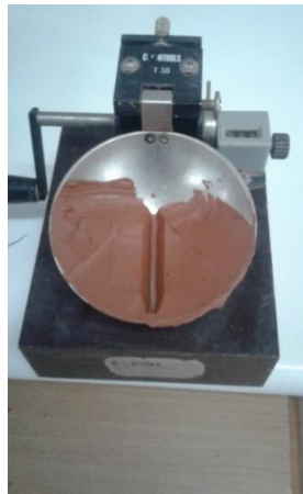
Figure II.6 : Réalisation de Rainure (labo génie civil a université d'Adrar) [Auteur]
