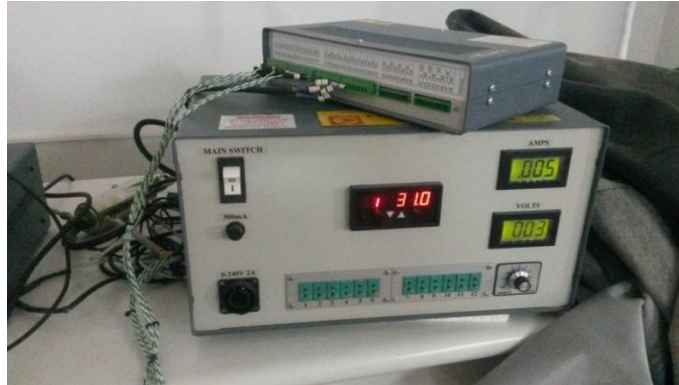
Figure III.15: L'appareil H112 de transfert de chaleur Unité de service(labo GC Université Adrar) [Auteur].
