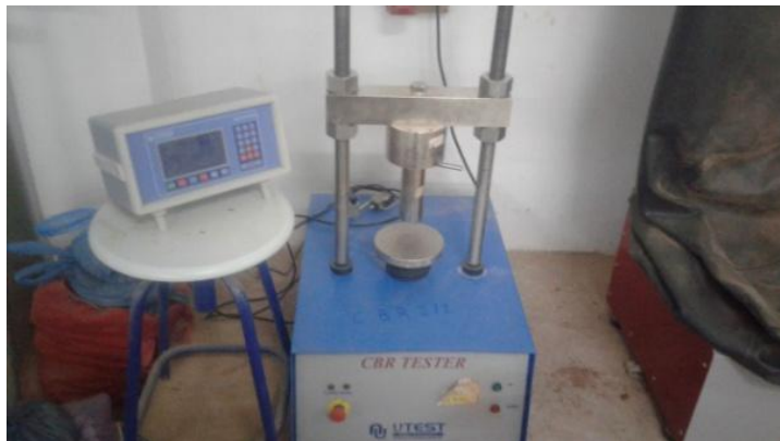
Figure II.9:Le CBR TESTER (labo génie civil a université d'Adrar) [Auteur]
