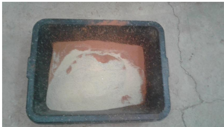
Figure III.17: Mélange 70% Argile + 20% Sable + 10% Plâtre [Auteur].
