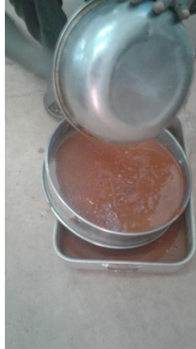
Figure II.5 : Opération de rinçage l'argile (labo génie civil a université d'Adrar) [Auteur].
