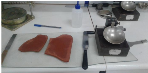
Figure III:Préparation de l'essai Limite d'Atterberg [Auteur]
