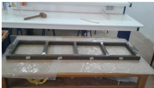
Figure III.16: Moule métallique utilisée pour préparer l'éprouvettes de la conductivité thermique
