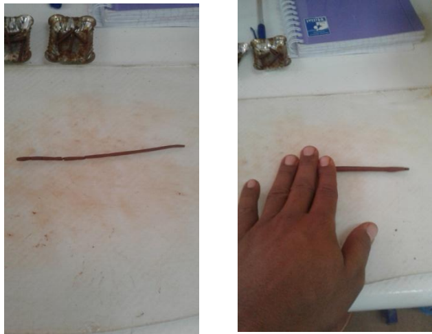
Figure II.7 :Réalisation de rouleau d'argile (labo génie civil a université d'Adrar) [Auteur]
