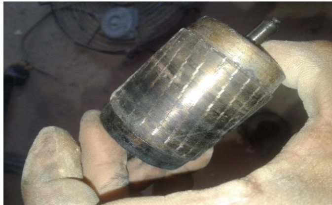
Fig. I.2 : le rotor à cage.
