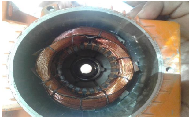
Fig: I.1: stator d'un machine asynchrone
