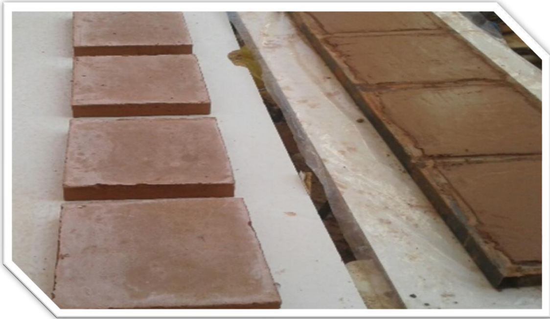
photo.IV.05 : photo de moulage et démoulage d'échantillons. (auteures)
