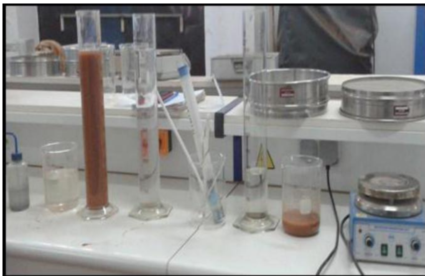
Photo IV.01: Analyse granulométrique d'argile par sédimentométrie [9]
