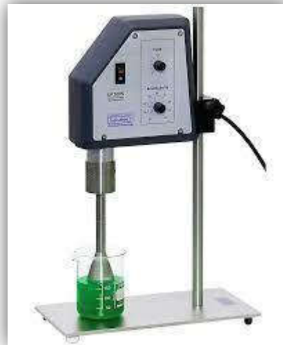
Figure12 : Extraction assistée par ultrasons (Sania et al. ,2020) .
