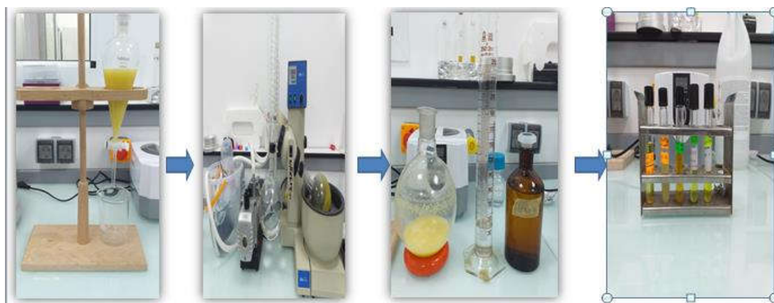
Figure 22 : Les étapes de fractionnement de la phase hydro-alcoolique dans des solvants polaires et apolaires.
