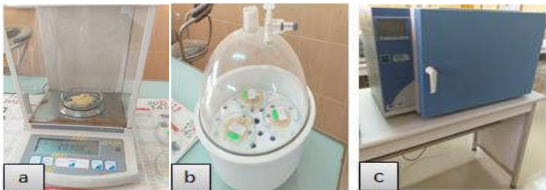
Figure 18: Pesée de l'échantillon (a), échantillons dans un dessiccateur (b), étuve isotherme (c)
