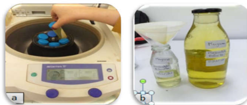
Figure 21 : Filtration de l'extrait par centrifugation(a), les trois filtrats obtenus (b)
