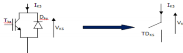
Fig. (I-25-a) Interrupteur bidirectionnel équivalent de la paire Transistor – diode. [18]
