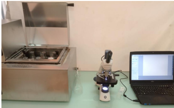
Figure 43 : Model expérimental de suivi de cristallisation oxalate de calcium par microscope optique (X 40)
