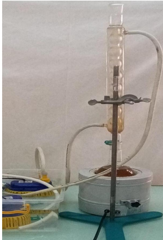
Figure 31 : Le montage d'extraction de la plante sous reflux (Décoction)
