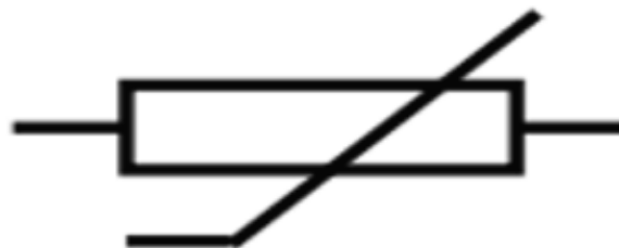
Figure 1. 18: Symbole communément utilisé pour représenter une thermistance.
