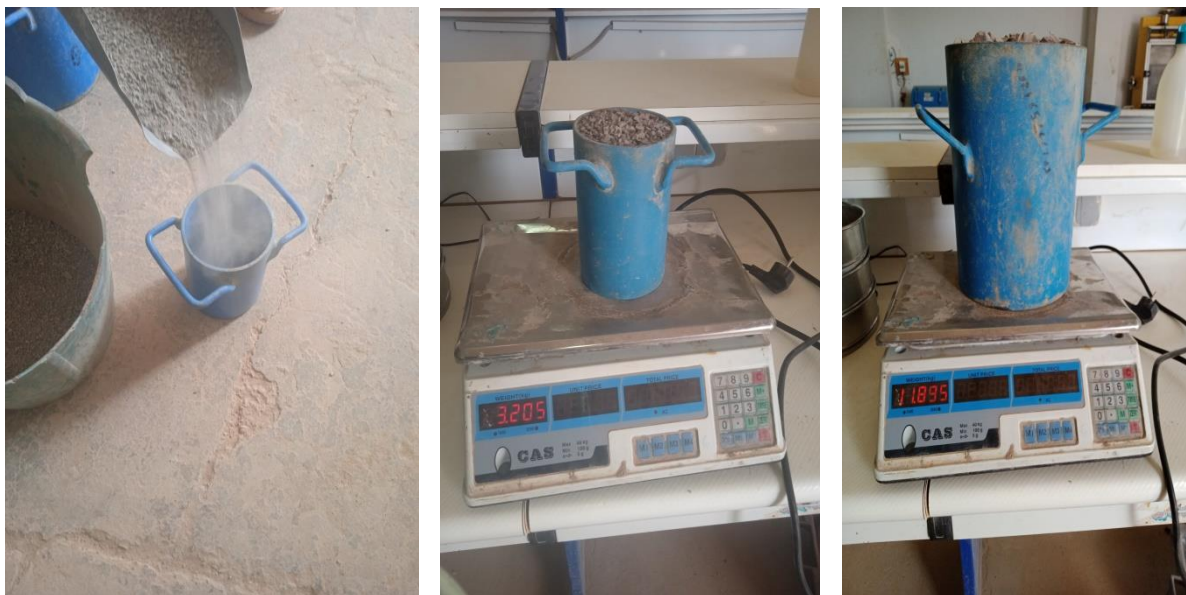
Photo 01 : la masse volumiques apparente de sable et gravier
