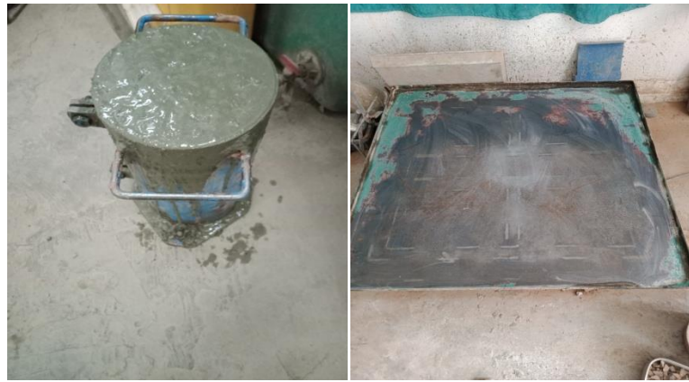
Photo N°11 : l'éprouvette après le vibration et le table vibration
