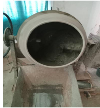
Photo N°07: Malaxage des matériaux
