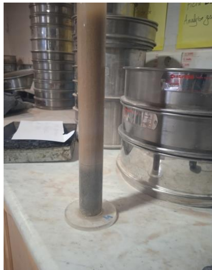
Photo N°1: Essai de l'équivalent de sable
