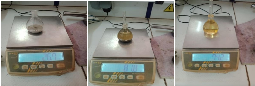
Photo N°4 : Essai de masse volumique absolue de ciment
