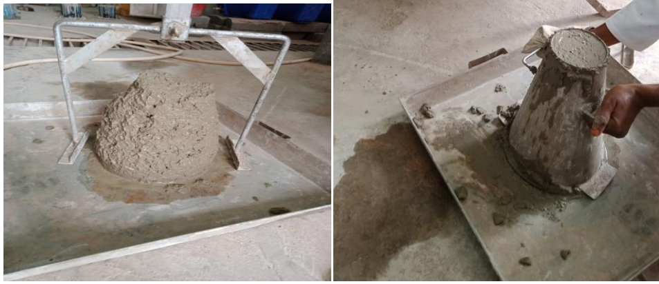
Photo N°08: Essai d'affaissement au cône d'Abrams
