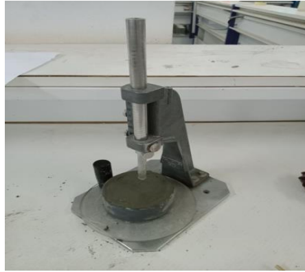
Photo N°03 : essai de prise (Vicat)
