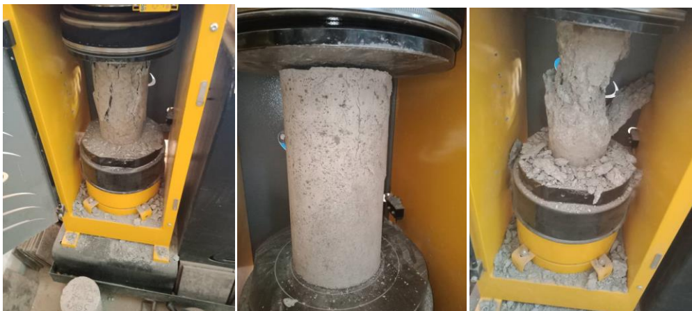
Photo N°13 : Essai de la résistance à la compression
