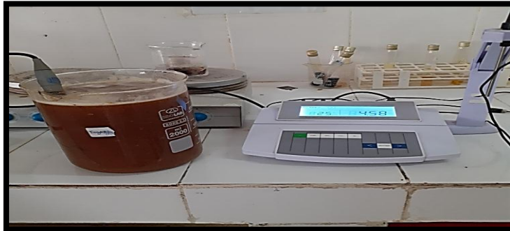
Figure 16 : Ajustement de pH 4,3 à 4,7
