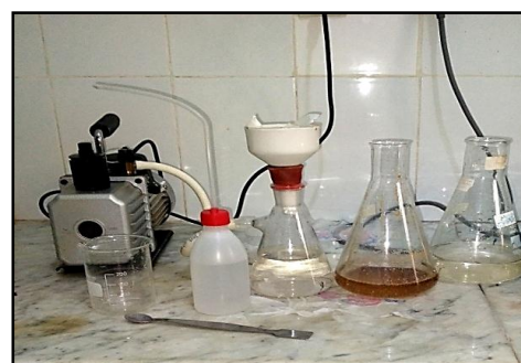
Figure 35 : Filtration avec pompe à vide
