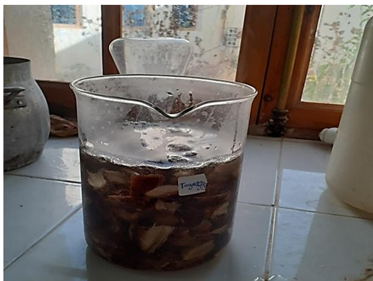
Figure 12 : Procédé d'imbibition (eau chaude 90°C)
