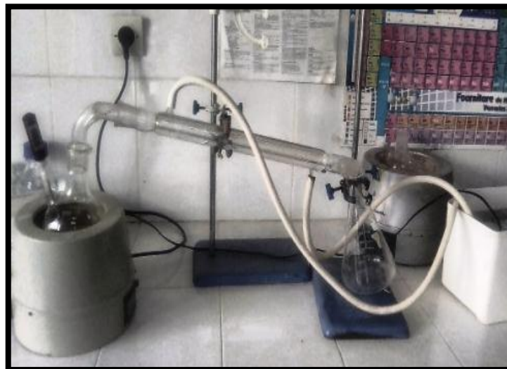
Figure 22 : Procédé de purification
