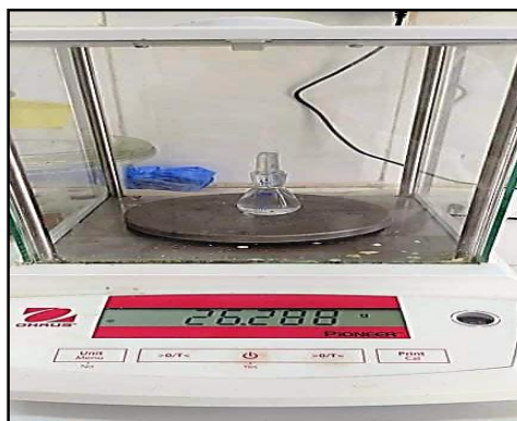
Figure 33 : Pycnomètre rempli à liquide
