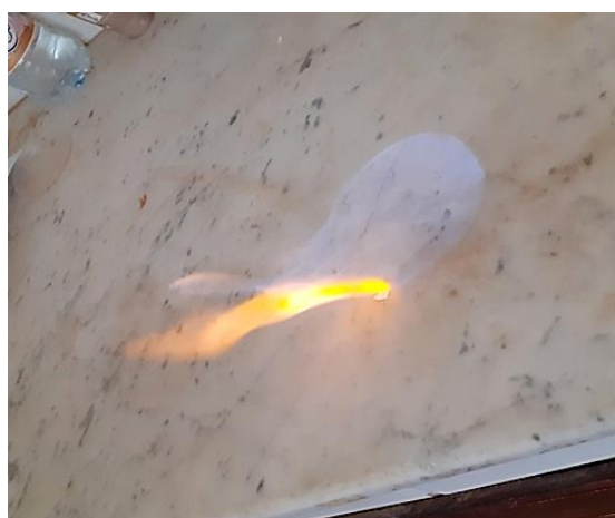
Figure 39 : Test d'inflammabilité de produit fini (bioéthanol)
