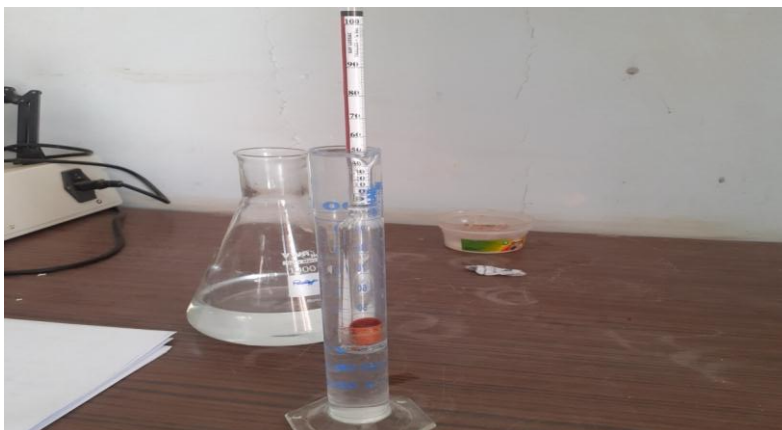
Figure 23 : Détermination le degré alcoolique
