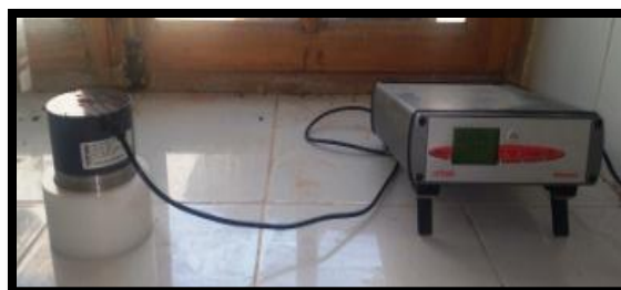
Figure 31 : Mesure de l'activité' d'eau par aw mètre
