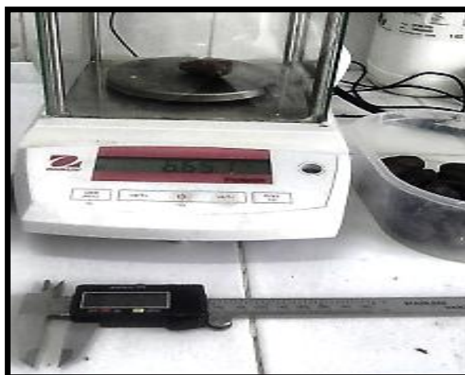
Figure 25 : Les matériels utilisés pour obtenu les paramètres morphologiques
