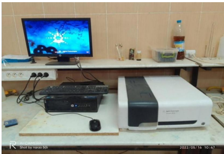
Photo4.spectrophotomètre UV utilisé pour le dosage des nitrates et le diagramme d'étalonnage.
