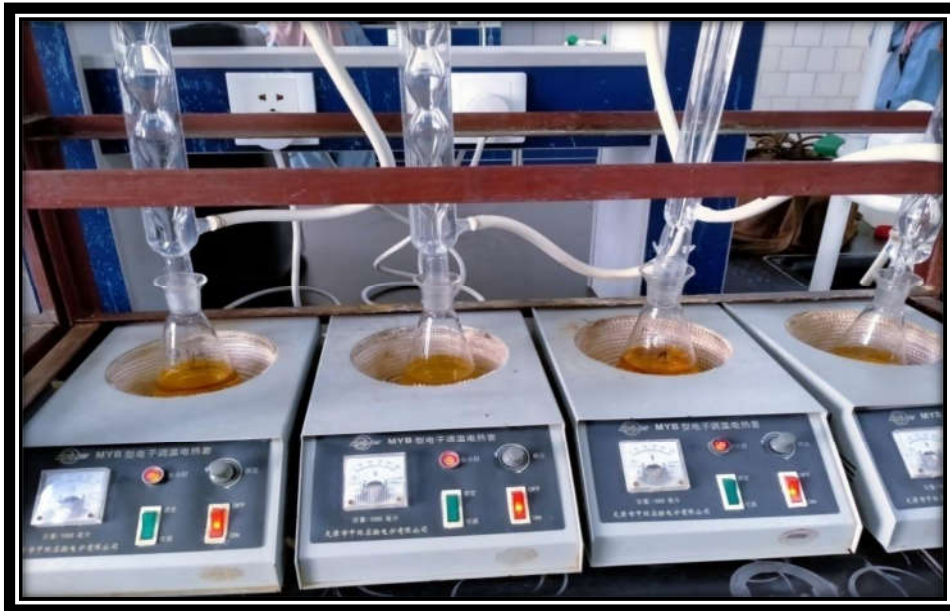
Figure. IV.15 : Réfrigérant les échantillons pour mesure le DCO.
