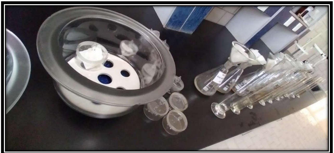
Figure. IV.18 : Méthode de filtration des matières en suspension .
