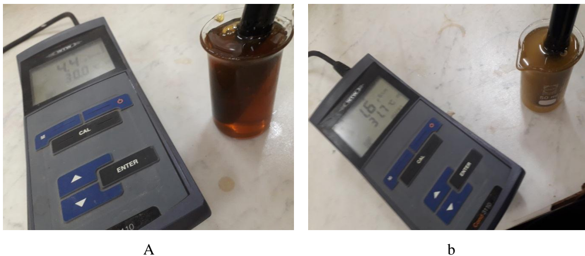
Figure III.15 : Mesure de la conductivité électrique du miel (a) et de la saccharose (b)
