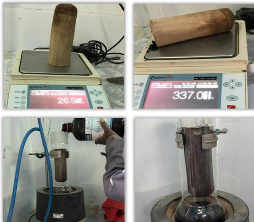
Photo IV.6 : Etapes d'extraction du bitume au Kumagawa.
