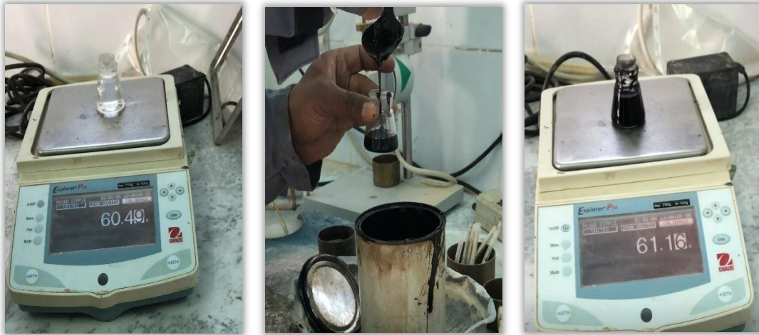
Photo III.10 : Matériels et étapes de déroulement de l'essai de densité relative sur bitume.
