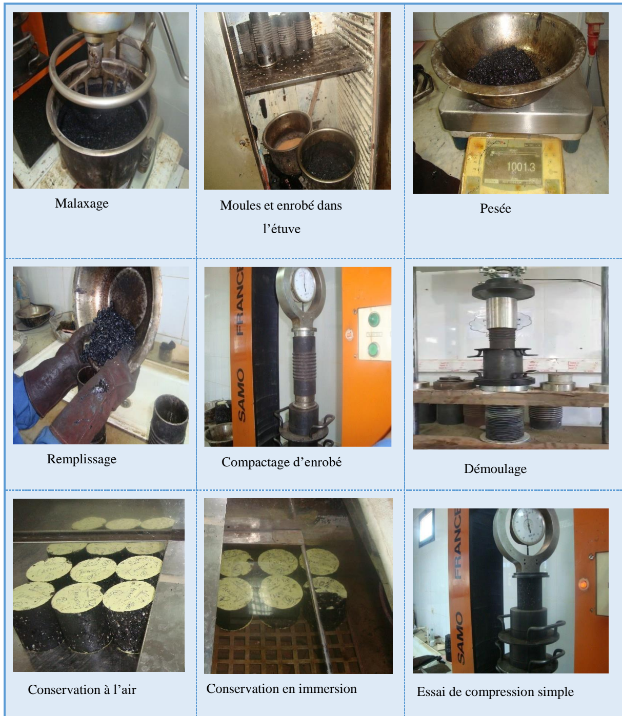
Figure III.7 : Etapes de préparation et conservation d'éprouvettes pour essai Duriez [14].
