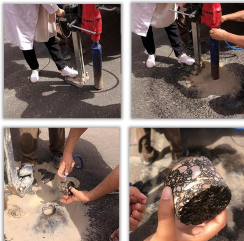
Photo IV.7 : Etapes de réalisation du carottage.
