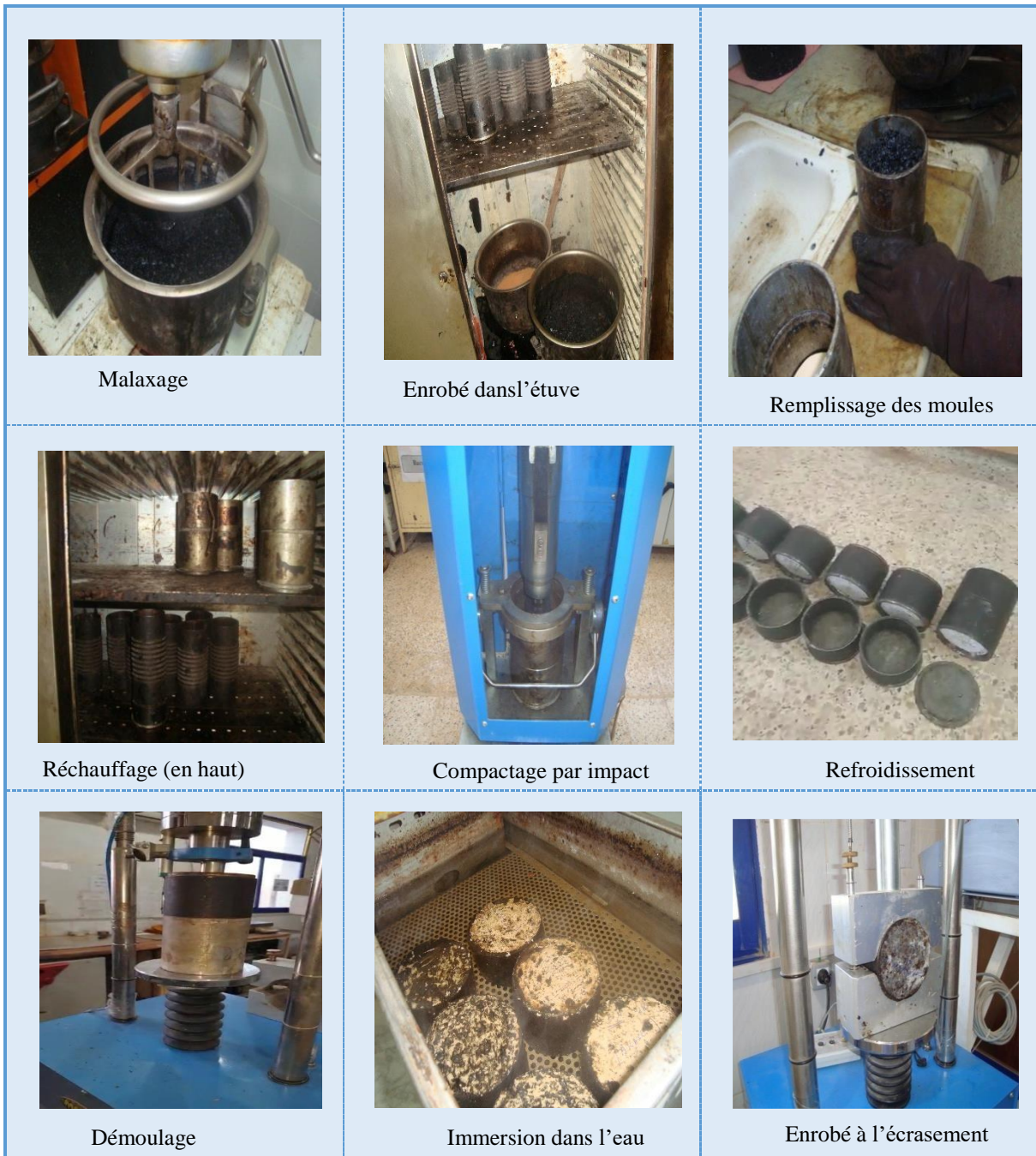
Figure III.6 : Etapes de préparation d'éprouvettes pour essai Marshall [14].
