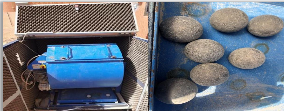
Photo III.6 : Equipement spécifique de l'essai Los Angeles.
