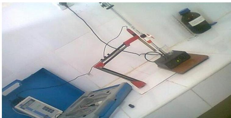
*Figure III. 13 : Mesure de pH.*
