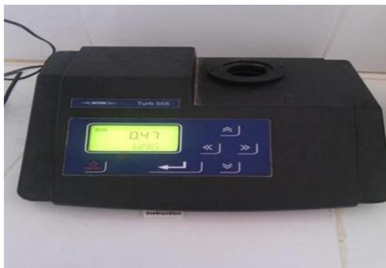
*Figure III. 16 : Turbidimètre.*
