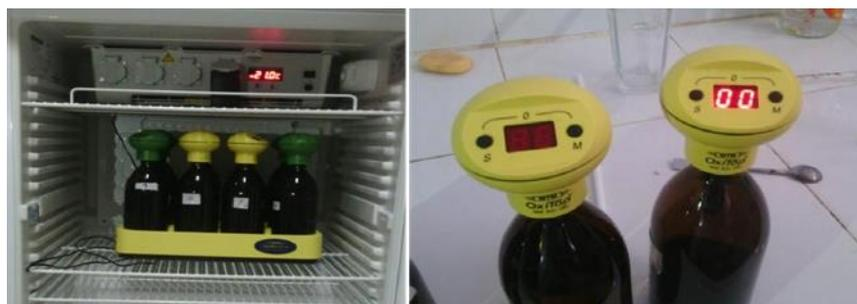
Figure III. 19 : Mesure de DBO5.
