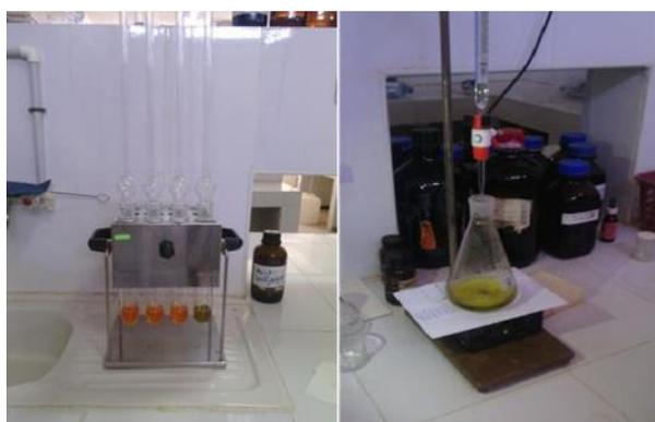
*Figure III. 18 : Détermination de DCO*
